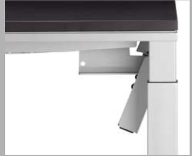
Elektrifizierung leicht gemacht: Der beidseitig abklappbare Kabelkanal garantiert eine schnelle, einfache Verkabelung des Tisches. Zum Herunterklappen des Kabelkanals werden die Entriegelungen einfach in Pfeilrichtung verschoben. Beim Hochklappen verriegelt sich der Kanal wieder von selbst.
