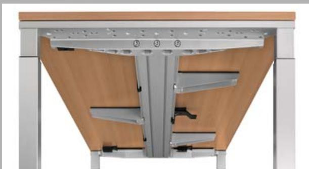
Der Blick unter den Tisch zeigt die Verbindungspunkte der Systemelemente: Während die Traverse und die Tischbeine an den Docks verschraubt werden, bietet die beidseitig profilierte Traverse Anbindungsmöglichkeiten für die Plattenunterstützung.
