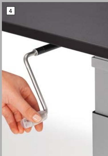
**4** Hydraulische Kurbelverstellung: Der Höheneinstellbereich von 65 bis 85 cm kann bei allen Gestellvarianten (4-/C-/T-Fuß) auf Wunsch auch mit einer leichtgängigen, hydraulischen Kurbelverstellung überbrückt werden.
